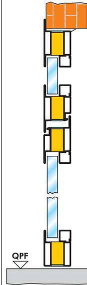
COD. 235 L - TELAIO "L" su muro - TELAIO "T" - ANTA "Z"
