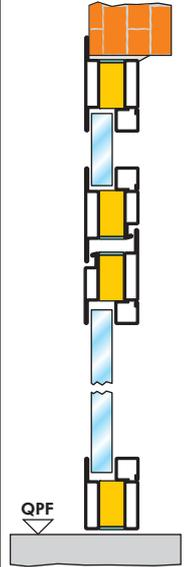
COD. 235 L - TELAIO "L" su muro - TELAIO "T" - ANTA "Z"
