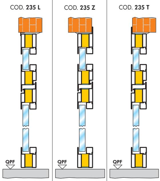
COD. 235 L - TELAIO "L" su muro - TELAIO "T" - ANTA "Z"
