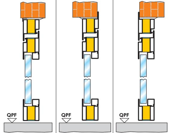
COD. 235 L - TELAIO "L" su muro - TELAIO "T" - ANTA "Z"
