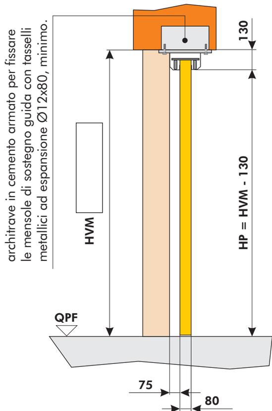
architrave in cemento armato per fissare le mensole di sostegno guida con tasselli metallici ad espansione Ø12x80, minimo.
