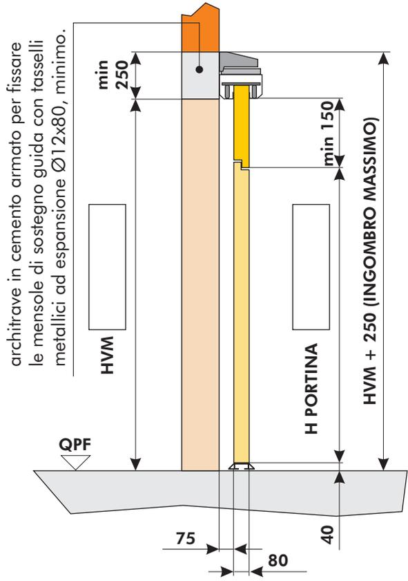
architrave in cemento armato per fissare le mensole di sostegno guida con tasselli metallici ad espansione Ø12x80, minimo.
