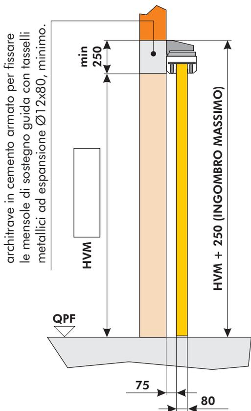
architrave in cemento armato per fissare le mensole di sostegno guida con tasselli metallici ad espansione Ø12x80, minimo.
