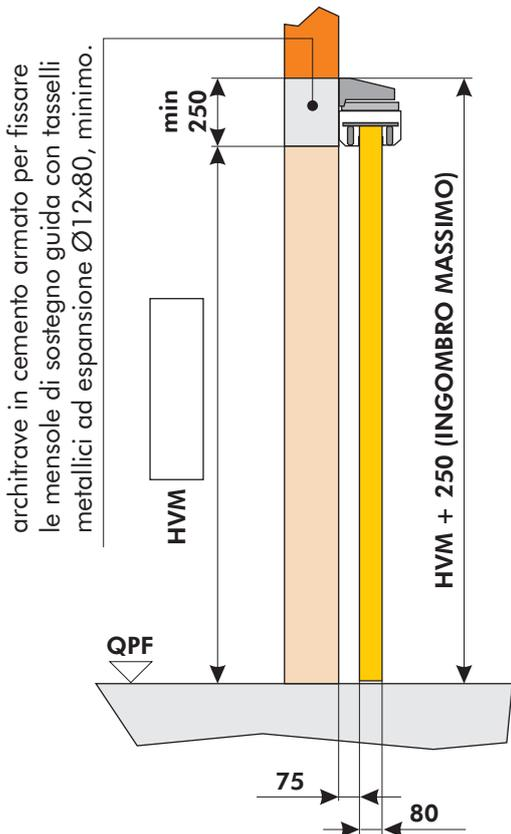
architrave in cemento armato per fissare le mensole di sostegno guida con tasselli metallici ad espansione  $\varnothing 12 \times 80$ , minimo.
